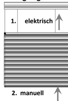
***Für die Scheibenreinigung den Behang zunächst hochfahren, dann die Unterleiste mit den Lamellen nach oben schieben und sichern (z.B. durch Papierbanderole)***
